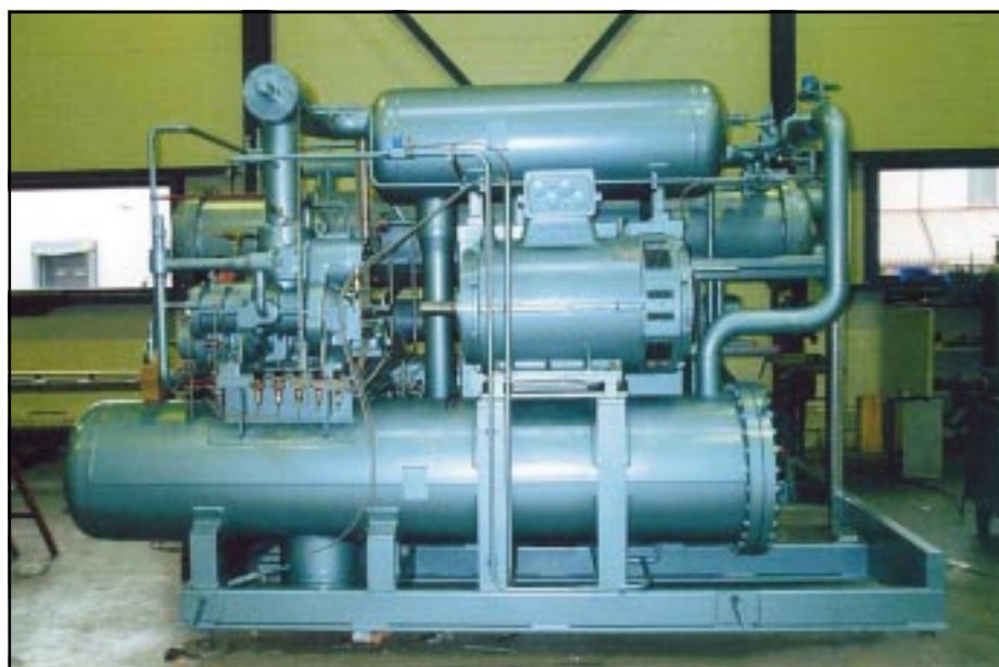
Afbeelding 9 – NH 3 -brine-chiller, bestemd voor het vriesschip 'Salica Frigo' ingericht voor het transport van o.m. diepgevroren tonijn, opgesteld in de fabriek. Vermogen: 816 kW bij 0/+40°C; voorzien van Grasso/KAB twin screw compressors en zeewatergekoelde shell and tube-condensers (titanium).
