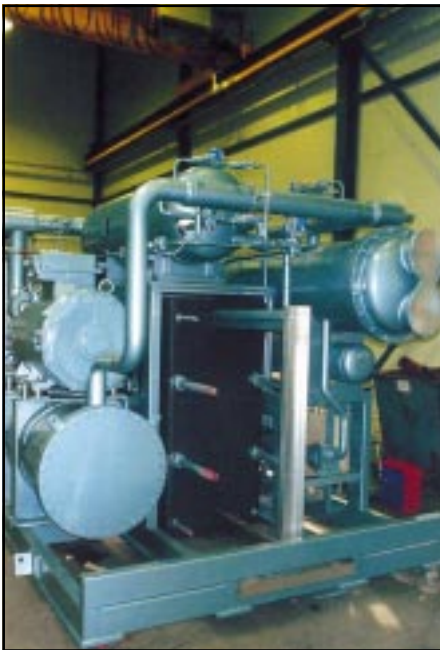
Afbeelding 10 – Brine chiller met platenwarmtewisselaar bestemd voor de 'Salica Frigo'
